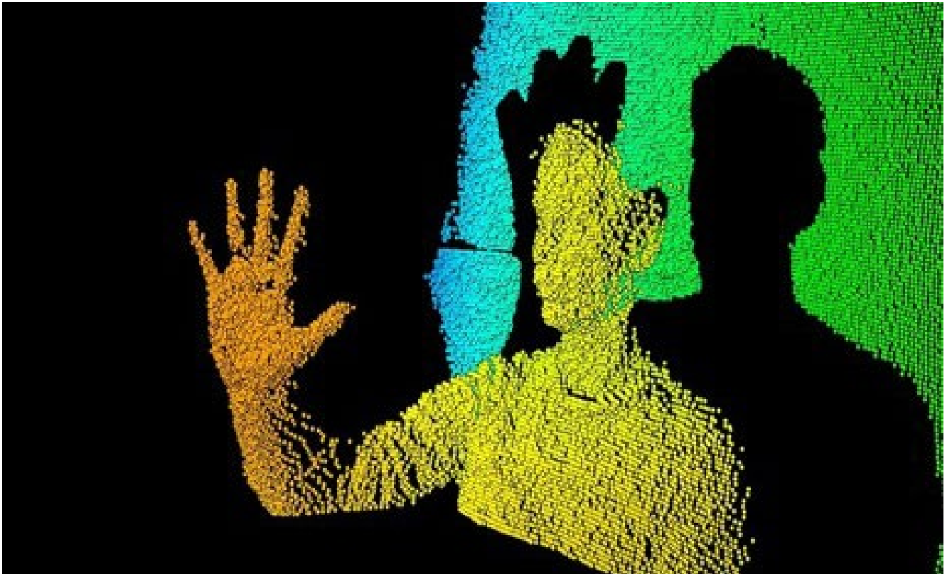
Abb. 7: Körpererfassung mit 3D-Time-of-flight-Kamera. Foto: Universität zu Lübeck
